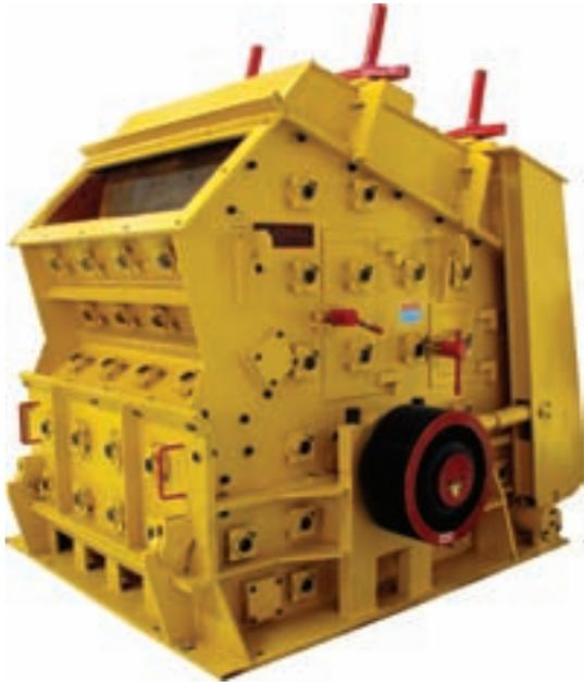
反击破结构简单，由机壳、转子和反击板组成。反击破的主要工作部件是带有板锤的高速旋转转子，在往返冲击过程中，物料块之间还相互碰撞。由于物料受到板锤打击，反击板的冲击以及相互间的碰撞，内部不断产生裂缝、松解，最后导致破碎；反击装置用来承受被板锤打击过来的物料，并将其反弹出去，主要部件是反击板，反击板用钢板焊成，其反击面上有耐磨衬板也有采用反击棒或蓖条板的。
